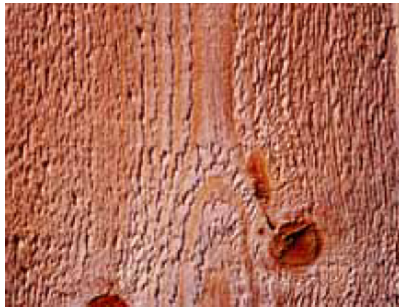
Vannesahattukin pinta on pörröisen tikkuinen ja vettä imevä. Särkisalon Falkbergin kartanon kenttävannesaha valmisti 1989 järeää puutavaraa restaurointeihin.
